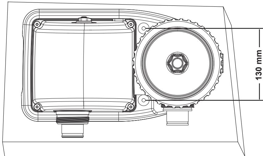
1. Otvori za montiranje su 6.4mm u prečniku i razmaknuti 130mm.
