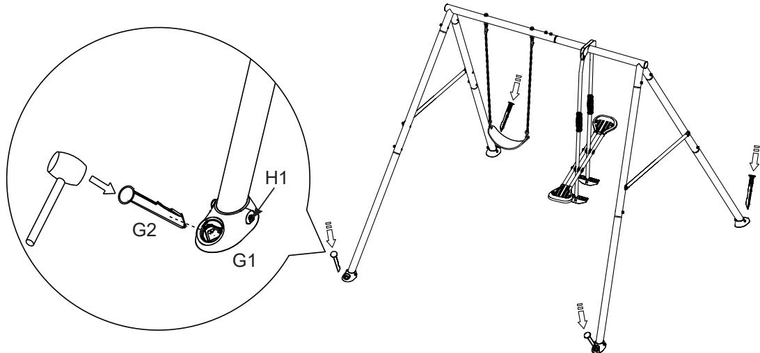
1. Učvrstite stope osnova za sidrenje u beton (nije priloženo). Poravnajte komplet ljuštački i označite lokacije za stope osnova za sidrenje. Iskopajte rupe prečnika 30 cm i dubine 35 cm.
